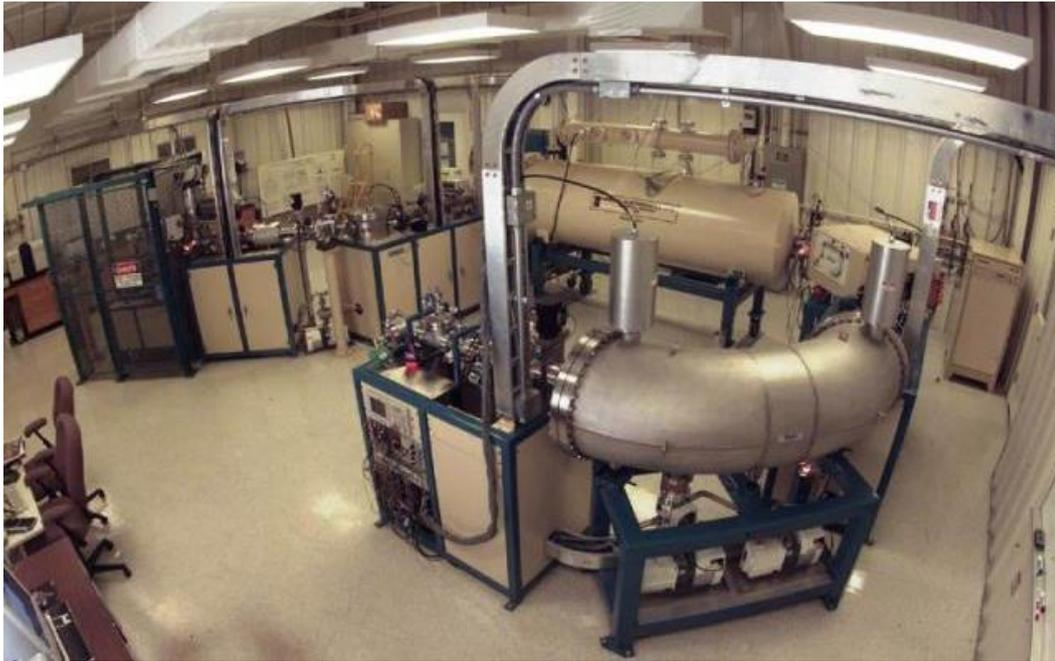
Spettrometro di massa con acceleratore (AMS) di recente costruzione presso il Lawrence Livermore National Laboratories (USA) <http://bioams.llnl.gov/equipment.php>
